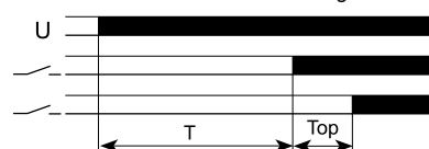
Funktion 27: 1 Relais anzugsverzögert 1 Relais nachlaufverzögert
