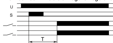
Funktion 33: 2 Relais anzugsverzögert nach Impuls
